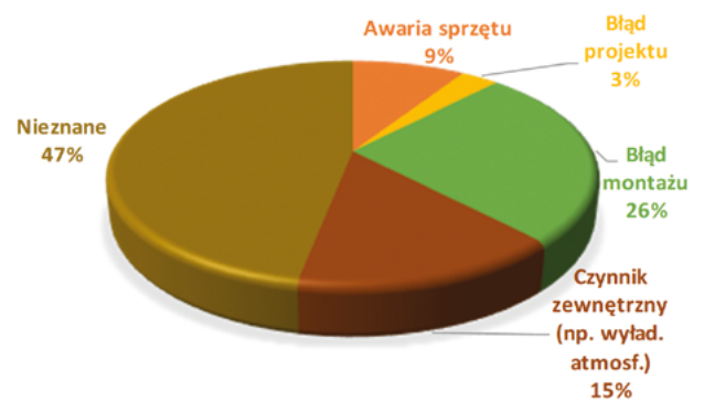
Rysunek 4: Przyczyny wystąpienia pożaru instalacji PV w Wlk. Brytanii (dane z BRE 2017a)
